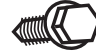
⑮ Tornillo de cabeza hexagonal (2) para la cubierta de la entrada del tubo de agua (5/8")*
