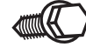
⑮ Tornillo de cabeza hexagonal (2) para la cubierta de la entrada del tubo de agua (5/8")*
